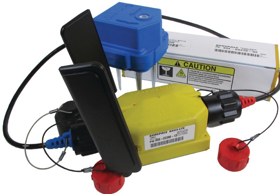
*GSX3-C con una batería BN18 y un geófono GS-ONE LF de tres componentes en un encapsulado de tierra*
